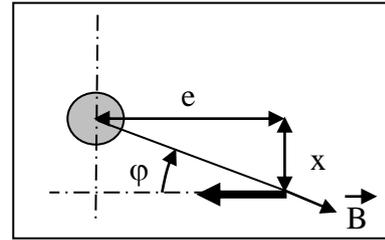
Composante du champ magnétique dans le plan du capteur :
