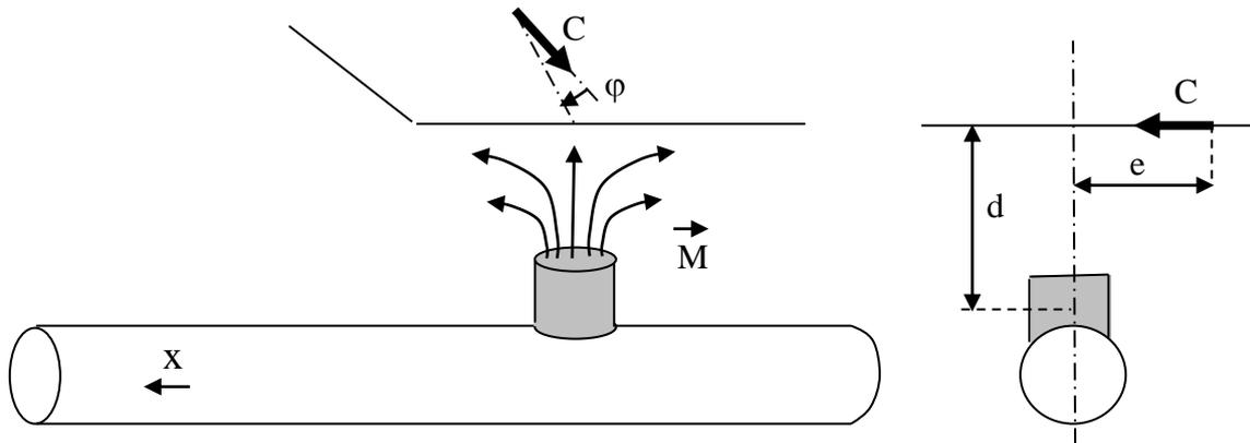
Utilisant des magnétorésistances montées en pont de Wheastons, le capteur délivre un signal de la forme :  $\Delta V = V_s S \sin 2\varphi$ , avec  $V_s$  la tension d'alimentation du capteur,  $S$  sa sensibilité et  $\varphi$  l'angle entre la composante du champ magnétique dans le plan du capteur et l'axe de ce dernier ( $\varphi = 0$  quand  $x = 0$ ).
