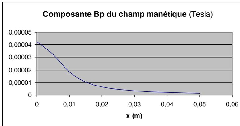
$$B_p > 10^{-5} \text{ Tesla si } -15 < x < +15 \text{ mm}$$
